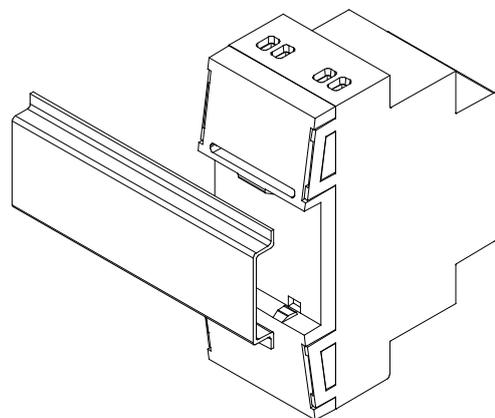
**Рисунок 3: Установка MINiBOX 20 на DIN рейку**
